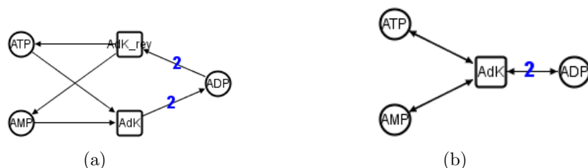
Abbildung 4.8: Modellierung reversibler Reaktionen. (a) Eine reversible Reaktion aufgespalten in eine Vorwärts- und Rückwärts-Transition in der Petri-Netz Darstellung. (b) Die gleiche reversible Reaktion als hierarchische Transition visualisiert.
